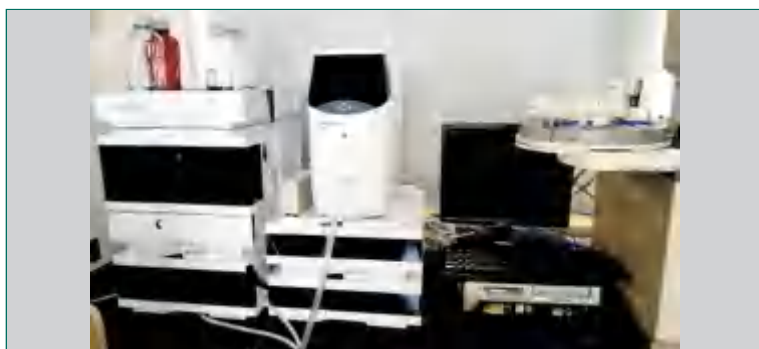
安捷伦1260液相色谱仪(Agilent 1260 HPLC)
